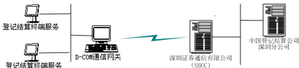
图 15.1. 系统连接示意图
