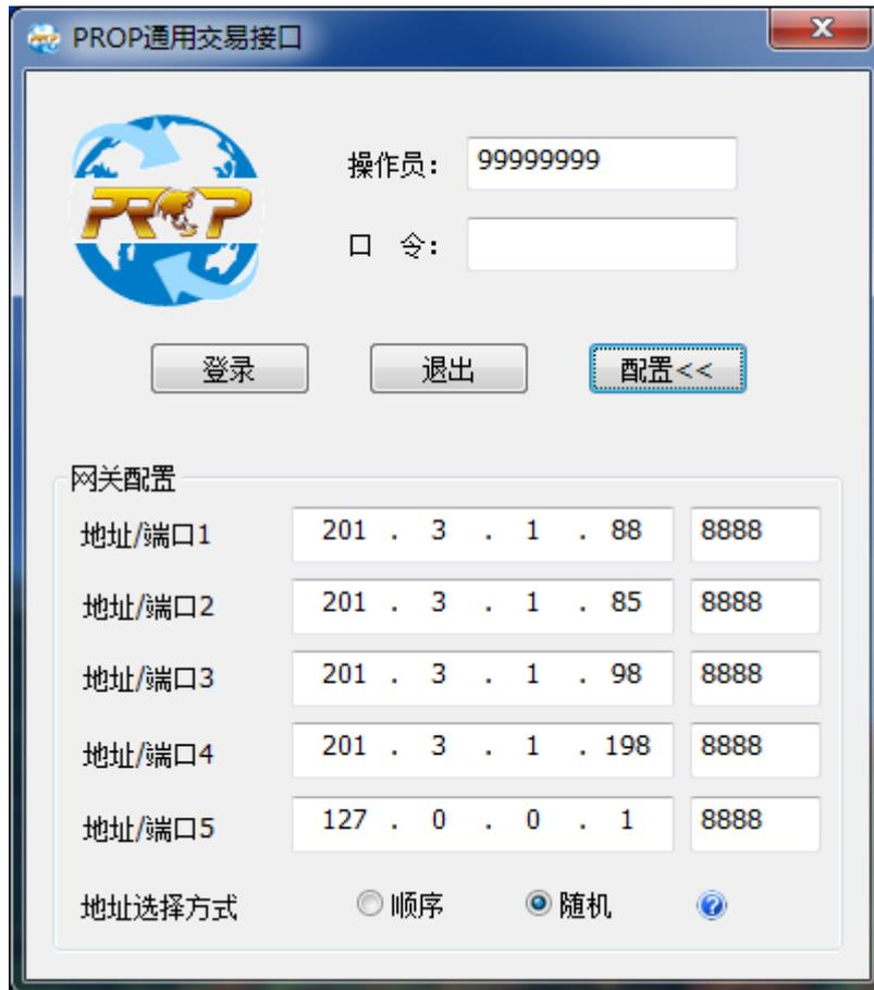
图 3.4 多网关地址配置
